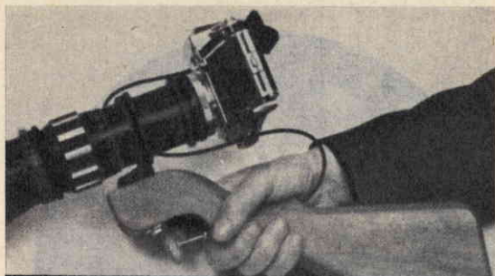
Fig. 3 - La figura illustra un esempio di impiego del calcio; la macchina montata è di tipo Leica con teleobiettivo potente da 400 mm. Si noti il diverso tipo di collegamento della macchina al calcio.
