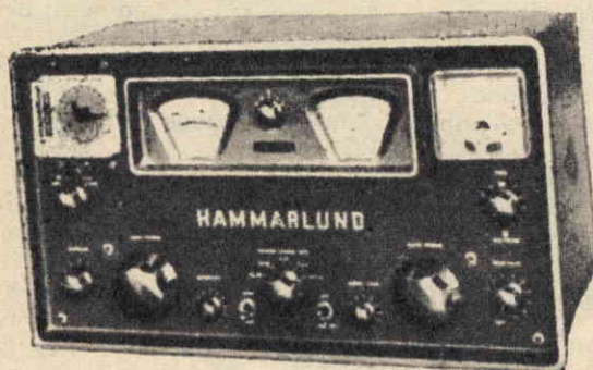
Fig. 5 - Ricevitore da 540 Kc a 30 Mc Bandsread per bande radiantistiche. S meter. L'apparato è di tipo italiano (Allochio Bacchini HQ 100 AE).
