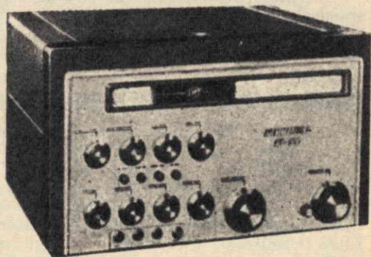
Fig. 6 - Trasmettitore per bande radiantistiche. Potenza d'uscita: 100 watt SSB, 100 W CW, 25 W AM, 100 W FM, 100 W FSK. VFO ad altissima stabilità. Tipo italiano (Allochio Bacchini HX 500 E).
